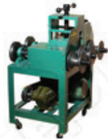
к938 Трубогиб трехваликовый мобильный, 1,5 кВт/220В, 730x630x1030мм (с валиками для прокатки круглых труб: 19, 22, 25, 32, 38, 51, 63, 76мм, для квадратных труб: 16x16, 20x20, 22x22, 25x25, 30x30, 40x40, 50x50мм).
