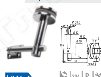
k241-4 304 P X Выносной держатель поручня на стекло 8-16 мм, регулируемый, с ложементом, вынос 85мм. отв в стекле нужно делать не менее 16мм.
