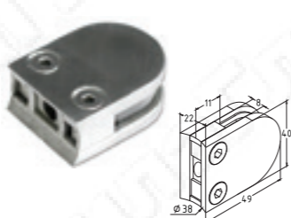
k001-5 Стеклодержатель литой с вставками под стекло 8 мм, закругленный под Ø38, 40x22x53, AISI 316
