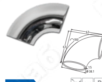
k095-4 316 P Отвод поручня \varnothing 38,1 \times 1,45 мм, 90^\circ , 400 Grit АISI 316, очень полированный, 800 Grit
