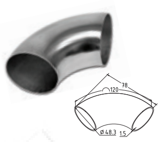
k237-120 304 P Отвод поручня \varnothing 48,3 \times 120 \times 1,5 мм, 90^\circ , 600 Grit
