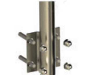
Удобный крепеж на 4 анкера: если один из анкеров попал в арматуру, это не беда: на 2-3 анкерах тоже будет отлично держаться. Если лень сверлить, можно приварить колпачковые гайки.
