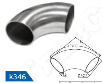
k346 201 304 P k346-3 201 304 P Отвод поручня \varnothing 42,4 \times 116 \times 1,5 мм, АISI 304, 400 Grit
