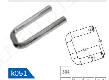
k051 304 316 P k051-3 316 P Оконч. поручня пандуса \varnothing 38,1 \times 1,5 мм, выпуски по 325мм для подгонки по месту до 300мм, 600GRIT
