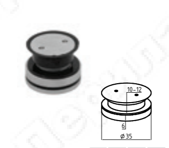
k643 Точечное крепление под стекло 10-12 мм, нерегулируемое 6 мм.
