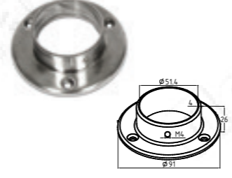
k022-4 304 S X Фланец настенный, для Ø50.8, под 3 самореза 4.8мм, 90x3мм, литой, шлифованный
