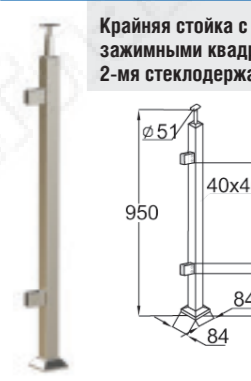
Ограждение террасы со стойками k749, прозрачным стеклом 10 мм и поручнем Ø50,8мм из нержавеющей стали.
