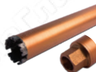
к411 Алмазная коронка для плитки, Ø56x360мм, 56x370, резьба внутренняя, гайка 1/2"
