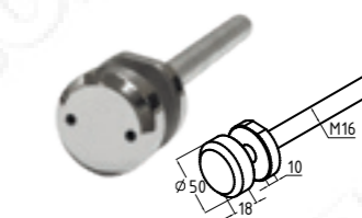
k277 Комплект торцевого крепления несущего стекла: гайка 50x18мм с внутр. М16, гайка прижим.50x10мм, в комп.шпилька М16x205мм и фторопластовые шайбы 50x1
