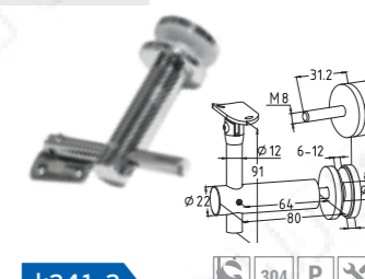
k241-2 304 P X Выносной держатель поручня на стекло 10-22 мм с регулировкой по высоте, вынос 110мм. отв в стекле нужно делать не менее 16мм.
