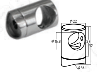
k018-4 Ригеледержатель на трубу Ø38,1 x 16,8 мм, AISI 316 , с потаем под вытяжную резьбовую заклепку
