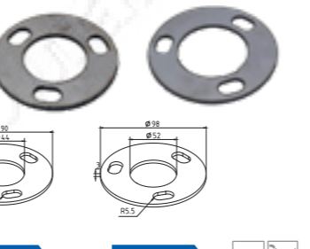
Ф-0451 Ф-0452 Ф-0453 Фланец нерж. 3-х анкерный (с овальным отверстием) Ф-0451 - \varnothing 38/90 Ф-0452 - \varnothing 42/90 Ф-0453 - \varnothing 50.8/90
