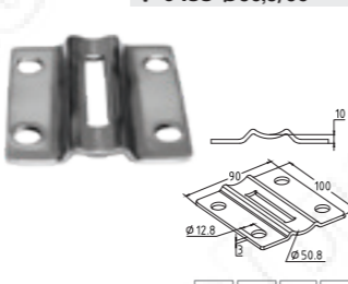
k056-4 Бок. крепеж пластина под стойку \varnothing 38 , вынос от стены 10мм, толщ. 3мм, сварка изнутри, без необх. зачищать шов AISI 304
