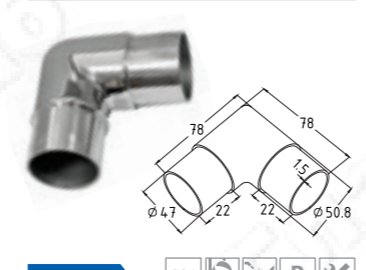
k280 304 P Поворот 90^\circ поручня \varnothing 50,8 \times 1,5 мм, литой угольник
