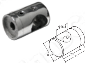
k065 Ригеледержатель на стойку под плоскость с отв. 16,8 мм, для ригеля 16мм, литой, внеш Ø22, высота 30 мм
