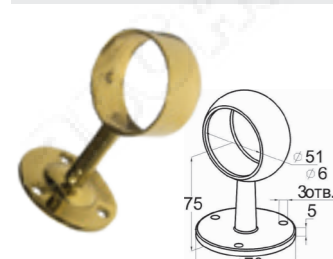
K066-88 Держатель поручня Ø50.8мм, выносной, с обхватом
