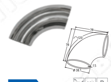
k095-5 304 P Отвод поручня 90^\circ , \varnothing 38,1 \times 120 \times 1,5 мм, удлиненный, очень полированный, 400 Grit
