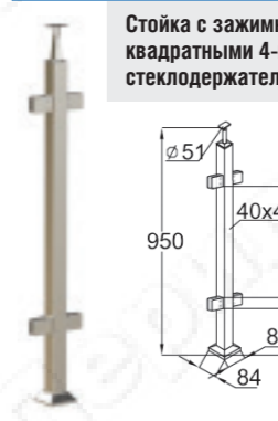
Ограждение террасы со стойками k749, прозрачным стеклом 10 мм и поручнем Ø50,8мм из нержавеющей стали.
