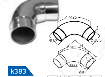
k383 304 P k383-3 304 P Отвод поручня под \varnothing 38,5 или \varnothing 42,4 \times 1,5 мм, 90^\circ , литой, с двумя установочными кольцами
