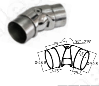
k011 Поворот литой, внутренний, регулируемый, 85 \pm 215^\circ , под \varnothing 50.8 \times 1.5 \text{ мм}
