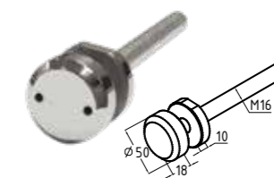
k277 Комплект торцевого крепления несущего стекла: гайка 50x18 мм с внутр. M16, гайка прижим.50x10 мм, в комп.шпилька M16x205 мм и фторопластовые шайбы 50x1
